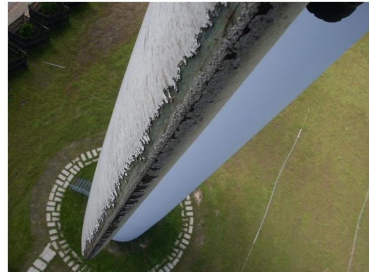
Erosion der Blattvorderkante eines Rotorblattes.
