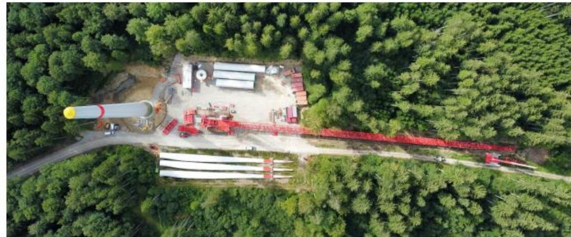
Abbildung 9: Lagerflächen und Fläche für den Aufbau des Kranauslegers zur Errichtung der Windenergieanlage
